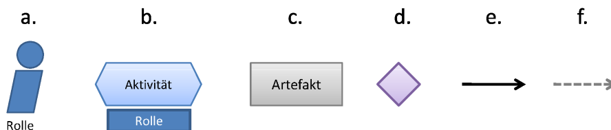
Abbildung 2.1: Legende der verwendeten grafischen Notation: (a) Rollen im Prozess, (b) Aktivitäten mit beteiligter Rolle, (c) Artefakte, Produkte, (d) Entscheidungspunkte, (e) zeitliche Abhängigkeiten, (f) Artefaktgenerierung.
