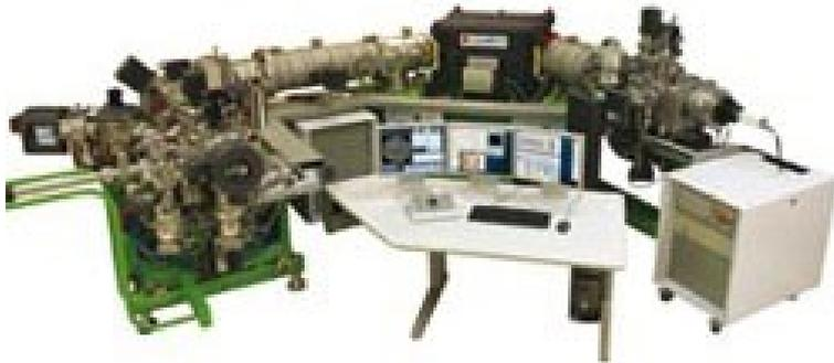
SIMS ist ein extrem leistungsfähiges Verfahren zur Bestimmung von Isotopenverhältnissen.
